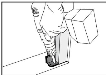
**6** Inserire i ferma guida alle estremità del profilo di chiusura.
