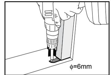
**5** Posizionare il supporto cassonetto e fissare con le viti in dotazione, a pavimento.
