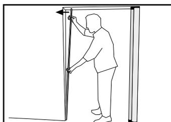
**8** Effettuare tre fori di fissaggio (superiore, centro e inferiore) e fissarlo con tasselli e viti in dotazione.
