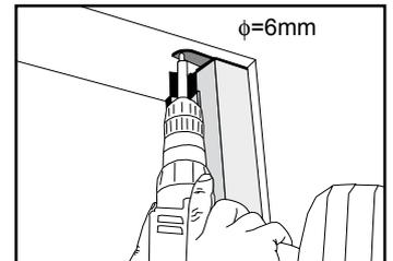
**3** Posizionare il supporto cassonetto e fissare con le viti in dotazione, nella parte superiore.
