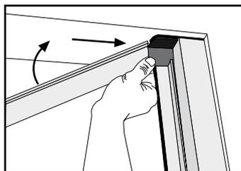
**12** ... successivamente nel profilo di chiusura, bloccarla con i ferma guida e fissarla con la vite in dotazione.
